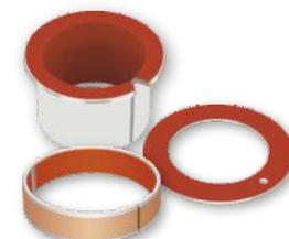
Die DP4-B Gleitlager bieten alle Vorteile von DP4<sup>®</sup> Lagern und zusätzlich den Vorteil eines antimagnetischen, korrosionsbeständigen Bronzerückens. Sie leisten in trockenen Betriebsbedingungen gute Dienste, insbesondere in Anwendungen mit intermittierendem Betrieb bei Hub- oder Schwenkbewegungen.
