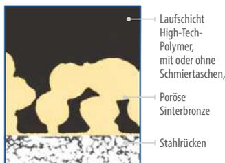
Laufschicht High-Tech-Polymer, mit oder ohne Schmieraschen
