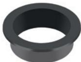
EP-Material für allgemeine Anwendungen bietet gute Gleitlagerleistung sowohl unter trockenen als auch unter geschmierten oder gering geschmierten Arbeitsbedingungen. Im Vergleich zu anderen Kunststoffwerkstoffen eine gute Wahl für mittlere Betriebsbedingungen.
